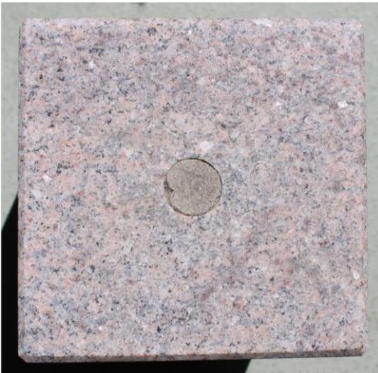
Abbildung 6: Außenbereichslagerungsversuche Start Juli 2020, Bohrloch nur gefüllt mit Monument Filler, keine Rissbildung, Datum der letzten Überprüfung: 28.04.2025
