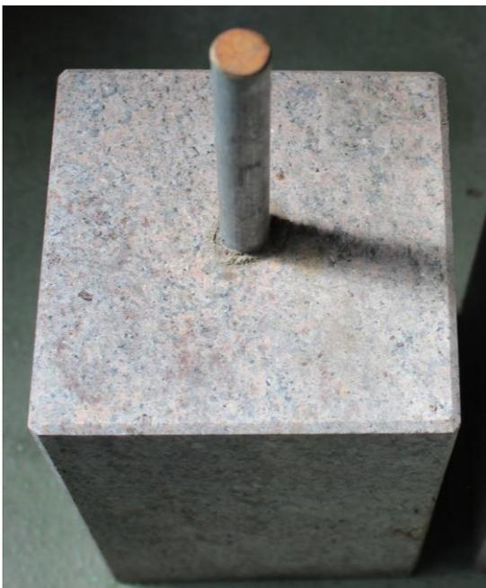
Abbildung 7: Außenbereichslagerungsversuche Start Juli 2020, Verbund Steinbohrloch mit Monument Filler und Metalldübel, keine Rissbildung, Datum der letzten Überprüfung: 28.04.2025
