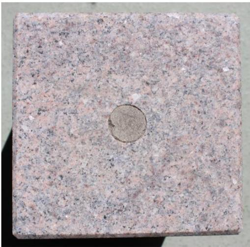
Abbildung 5: Außenbereichslagerungsversuche Start Juli 2020, Bohrloch nur gefüllt mit Monument Filler, keine Rissbildung, Datum der letzten Überprüfung: 28.04.2025
