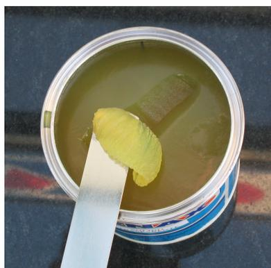
Avant d'appliquer le produit, s'assurer que le matériau est propre, sec et exempt de poussière. Prélever dans le récipient la quantité nécessaire de mastic à utiliser, ajouter 2-3 % de pâte durcissante, mélanger vigoureusement et procéder à l'application.
